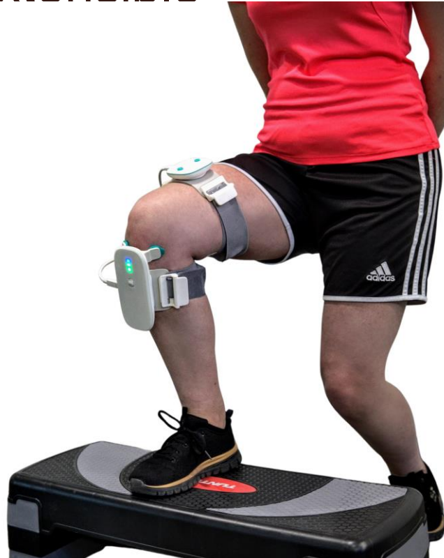
EEG + ECG + EDA: Stress monit. config.
